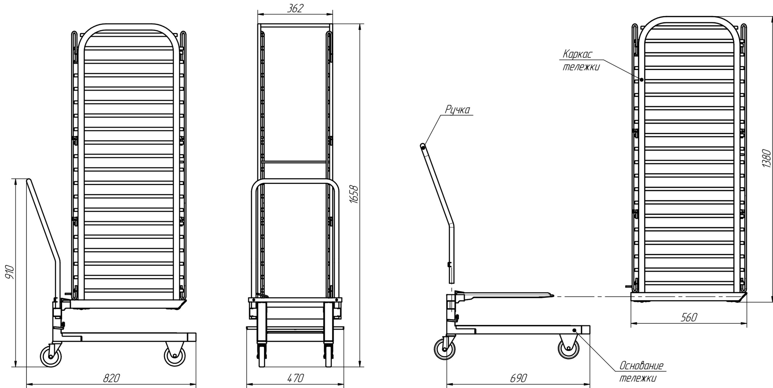
Тележка ТШ-20-1/1 для ШОК-20-1/1Т-01 и ПКА 20 предназначена для перемещения функциональных емкостей GN 1/1\* и размещения их внутри рабочих камер изделий ШОК-20-1/1Т-01 и ПКА 20.
