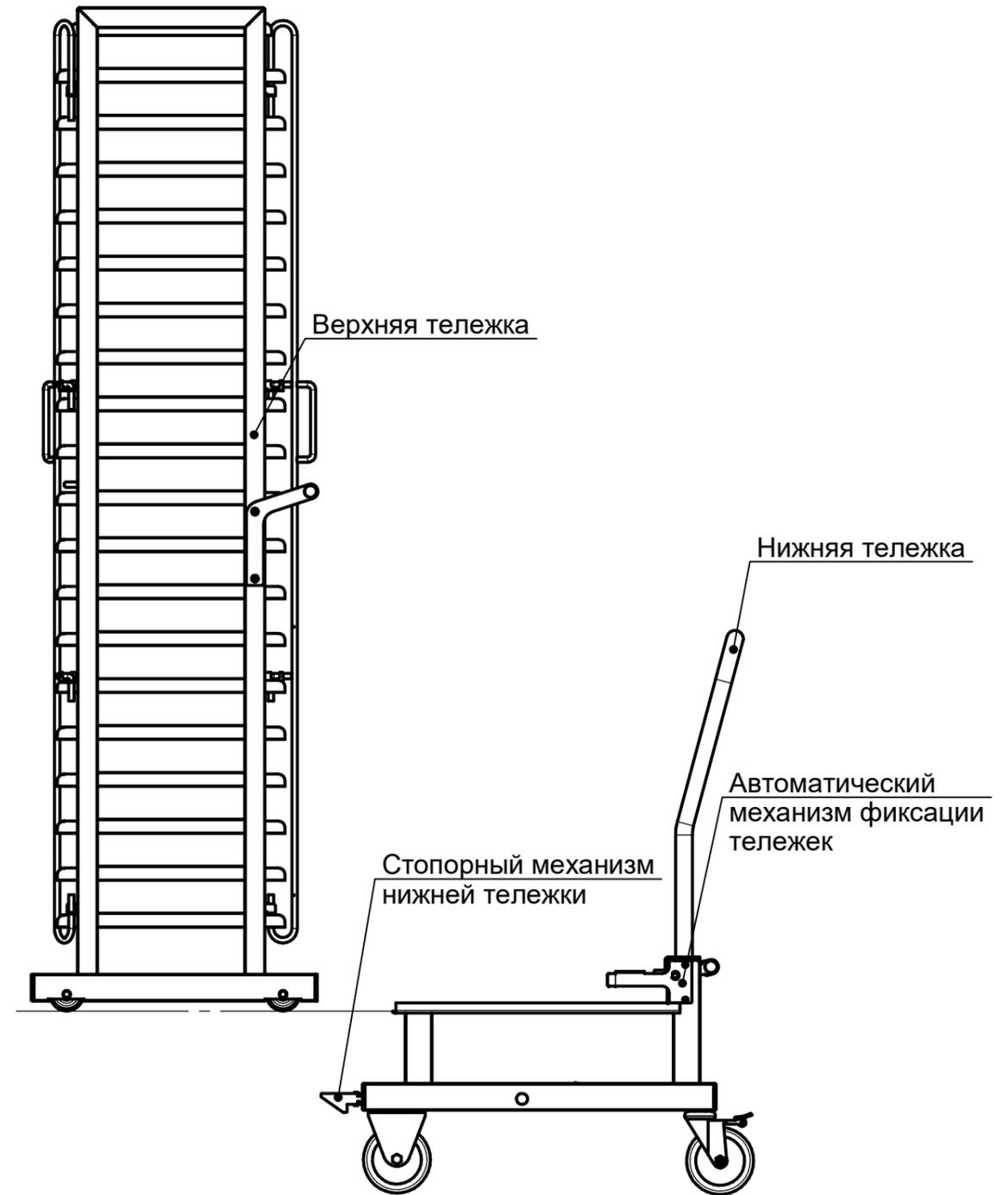
Тележка ТДШ-40-11 для шкафа шоковой заморозки предназначена для перемещения функциональных емкостей GN 1/1\* и размещения их внутри рабочих камер изделия ШОК-40-01 (шкаф вмещает две тележки).
