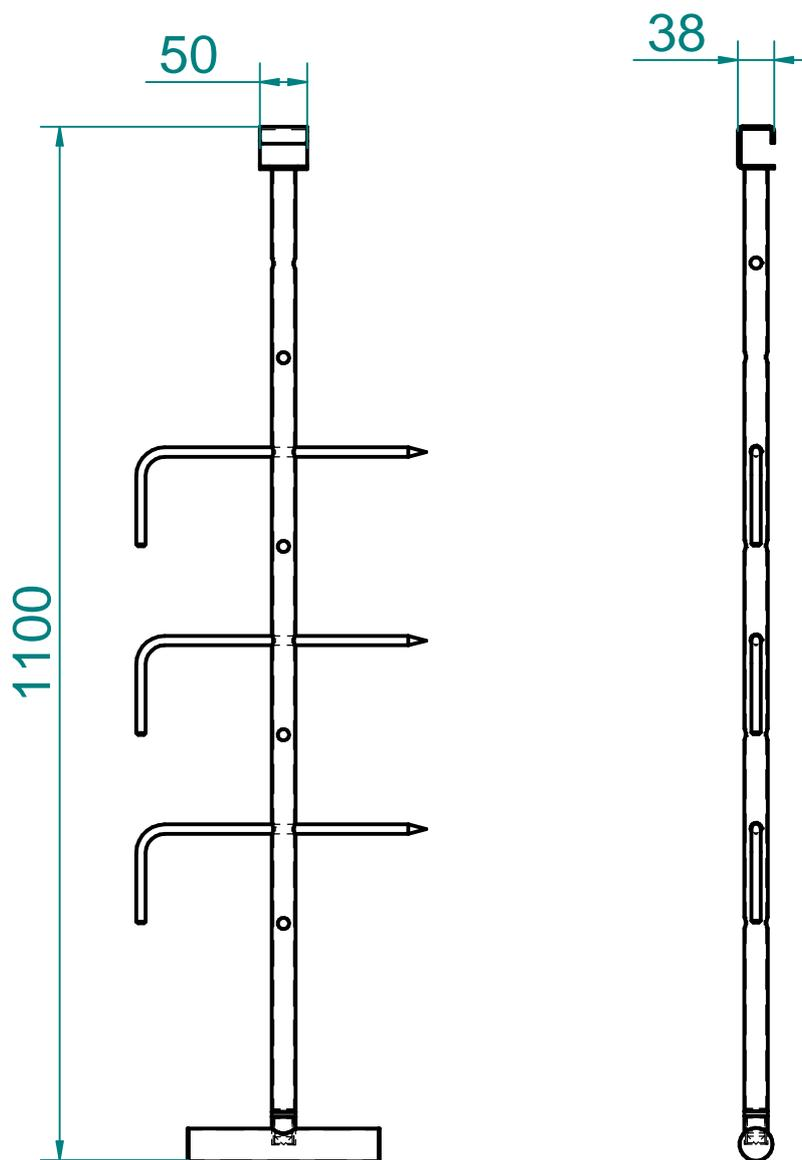
Спица СГТ-20 предназначена для подвешивания тушки ягненка и поросенка на тележке ТП20-1/1 ПКА20. Спица оснащена тремя штырями для фиксации туши.
