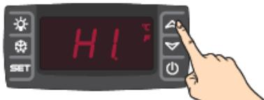
Нажать и отпустить кнопку **▲** отобразится сообщение "Hi", а затем минимальная достигнутая температура. Чтобы вновь отобразить фактическую температуру, снова нажать кнопку **▲** или подождать 5 секунд.
