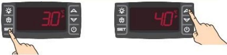
Нажать и удержать в течение 3 секунд кнопку **SET**, чтобы отобразить температуру, светодиодные индикаторы "C°" или "F" начнут мигать. Чтобы изменить температуру, нажать на кнопку **▲** для ее увеличения или на кнопку **▼** для ее уменьшения. Чтобы внести ее в память, снова нажать кнопку **SET** или подождать 10 секунд.
