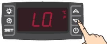
Нажать и отпустить кнопку **▼**, отобразится сообщение "Lo", а затем минимальная достигнутая температура. Чтобы вновь отобразить фактическую температуру, снова нажать кнопку **▼** или подождать 5 секунд.
