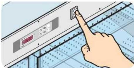
Вставить вилку в розетку и нажать выключатель, чтобы включить устройство. Цифровой контроллер запустит быстрое тестирование и светодиоды начнут мигать в течение нескольких секунд.
