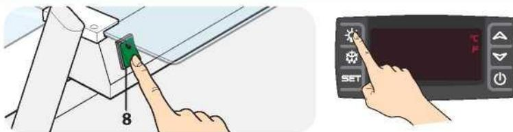
Если оборудование оснащено верхней надстройкой, воспользуйтесь выключателем (8), чтобы включить подсветку на осветительном или нагревательном элементе.
