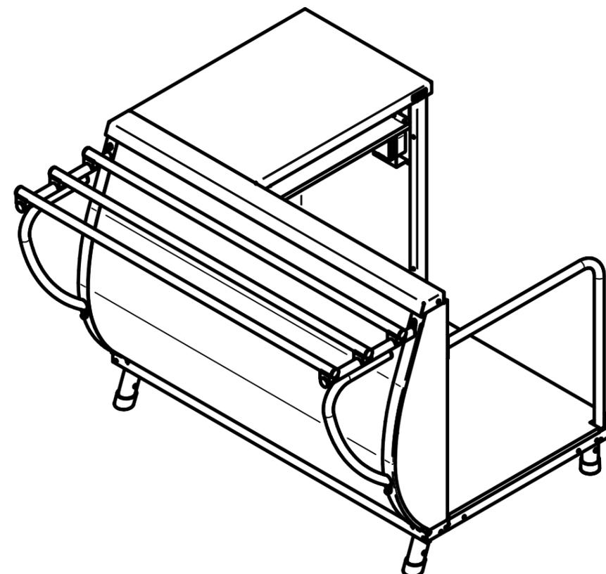
Кассовая кабина предназначена для установки на нем кассового аппарата и расчета с потребителями. Внизу имеется дополнительная полка и розетка 230В для подключения кассового аппарата. Путем несложного монтажа можно установить кассовую кабину как в левом, так и в правом исполнении. Направляющие для подносов входят в комплект поставки. Прилавок имеет регулируемые по высоте ножки.
